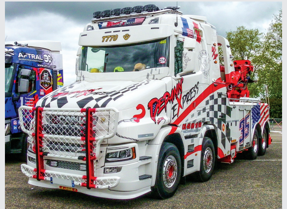
Ce Véhicule est devenu exceptionnel sur nos routes Française, il est souvent issu de longue démarche auprès de constructeurs, de carrossiers. Car il n'est plus au catalogue de chez Scania, il est donc issu d'un camion de série, ici à la base un Scania T770CH à cabine avancée, par la suite transformé chez un carrossier ici (Brevet) et équipé par Jigé avec une rotator 1175. ★ This is an exceptional recovery vehicle on French roads, the result of a long process with manufacturers and builders. Because it is no longer in the Scania catalog, it comes from a production truck. This is a basic Scania T770CH with an advanced cab, subsequently transformed by a coachbuilder here (Patent) and equipped by Jigé with a 1175 rotator.
