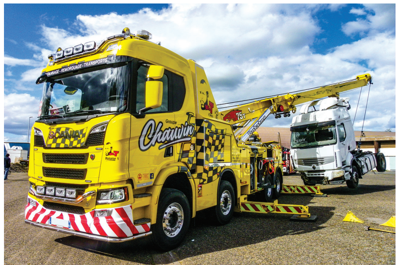
Cette démonstration à été réaliser par la société Chauvin représenté avec ce Scania de 660CH et équipé par Jigé avec le modèle Rotateur 1175, et la société Henrion avec ce Volvo FH13 de 540CH équipé encore par Jigé avec un autre modèle qui est la Rotateur 1140. ★ This demonstration was carried out by the Chauvin company (equipped with a 660HP Scania and a 1175 rotator model by Jigé) and the Henrion company (equipped with a 540HP Volvo FH13 and a 1140 model rotator also by Jigé).
