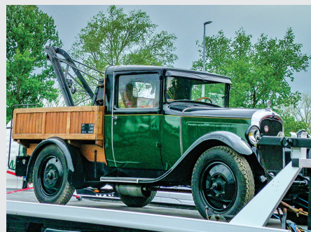
Il s'agit d'une Citroën C4 1000 kg donc utilitaire datant de 1929, 9 cv, moteur positionné longitudinalement de 4 cylindres en ligne, soupapes latérales, culasse et bloc en fonte, 1767 cm3, 32 cv, propulsion avec boîte 3 vitesses non synchronisée, carburateur simple corps, suspension lames de ressorts. Freins à tambours avants et arrières commandés par câbles et un servofrein mécanique à dépression. ★ This is a Citroën C4 1,000 kg utility vehicle dating from 1929, 9 hp, longitudinally-positioned 4-cylinder in-line engine, side valves, cast iron cylinder head and block, 1,767 cm3, 32 hp, propulsion with 3-speed non-synchronized gearbox, single-body carburetor, leaf-spring suspension, cable-controlled front and rear drum brakes, and a mechanical vacuum brake booster.
