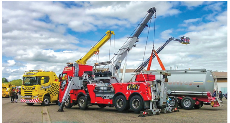
Ce Scania R770 10x6/4. Rotateur 1175S HHU Century Miller Industries. Construite en Angleterre chez boniface Engineering. Treuil 2x27 T, 2x 15T et 27T. À noter aussi que les gyrophares bleus sont autorisés dans son pays d'origine. Ce genre de véhicule n'est pas présent sur le territoire français, celui-ci à rouler 2 jours pour venir participer au grand défilé FDD. ★ This is a Scania R770 10 x 6/4 with a 1175S HHU rotator from Century by Miller Industries. It was built in England at Boniface Engineering (winch 2 x 27T, 2x 15T and 27T). Note that blue flashing lights are authorized in its country of origin. This type of vehicle is not available in France. This one had to be driven for two days to participate in the great FDD parade.
