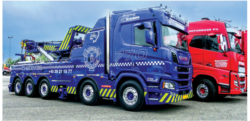
Ce Scania R770 10x6/4. Rotateur 1175S HHU Century Miller Industries. Construite en Angleterre chez boniface Engineering. Treuil 2x27 T, 2x 15T et 27T. À noter aussi que les gyrophares bleus sont autorisés dans son pays d'origine. Ce genre de véhicule n'est pas présent sur le territoire français, celui-ci à rouler 2 jours pour venir participer au grand défilé FDD. ★ This is a Scania R770 10 x 6/4 with a 1175S HHU rotator from Century by Miller Industries. It was built in England at Boniface Engineering (winch 2 x 27T, 2x 15T and 27T). Note that blue flashing lights are authorized in its country of origin. This type of vehicle is not available in France. This one had to be driven for two days to participate in the great FDD parade.
